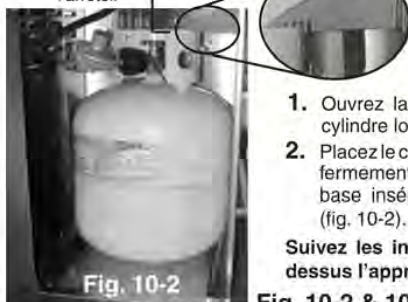
Fig. 10-2 & 10-3. Trois étapes faciles à fixer votre cylindre de gaz de propane.
