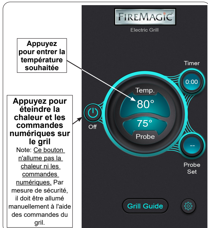
Fig. 6-3 Températures affichées sur l'application
